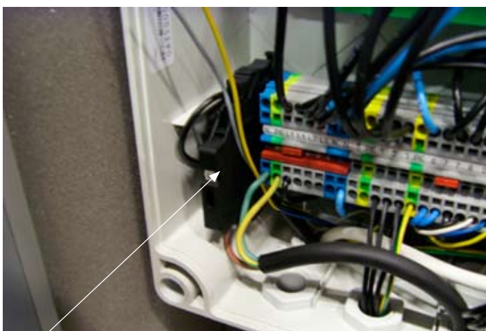
Sicherungshalter in L-sockel drücken.
