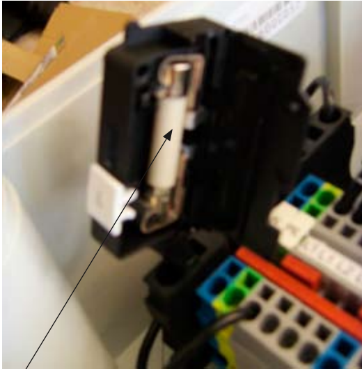
Eine 6-A-Sicherung (schnelle, nicht träge) in den Sicherungshalter einsetzen, falls nicht bereits vorhanden.
