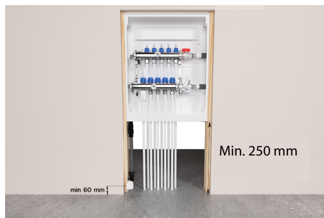
Exempelbild på montering av skåpet med 250 mm avstånd från golvytan.
