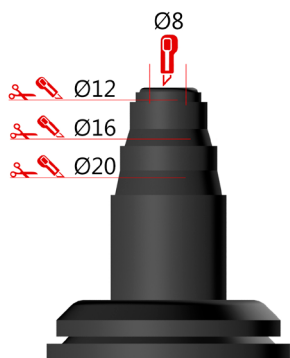
Kapning av rör genomföring.
