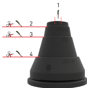
Kapning av rör genomföring.
