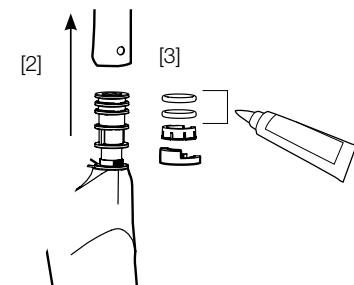
**SE** Byte av tätningsringar
