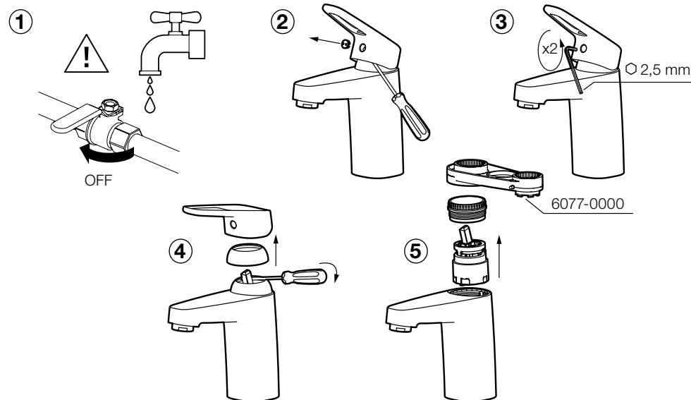
**SE** Byte av tätningsringar
