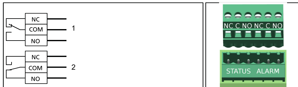
Bild 11: Elektriskt anslutningsschema samlingsfelmeddelande
