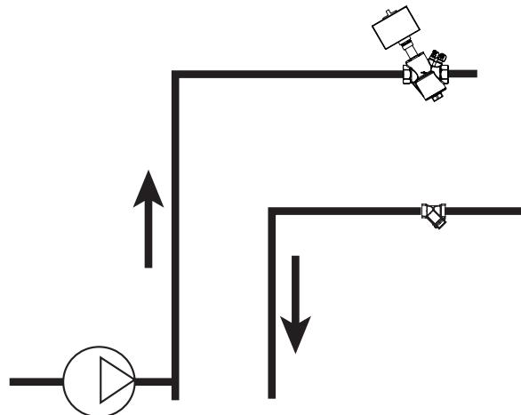
Kan monteras både på tillopp och retur. Vi rekommenderar att man även monterar smutsfilter och avstängningsventil. Temperaturen runt ställdonet bör inte vara under 0°C. TOV kan endast användas som avstängningsventil då trycket kommer i pilens riktning.
