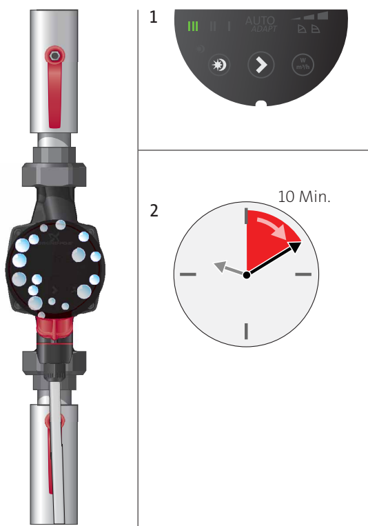
Fig. 27 Avluftning av pump
