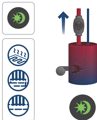
Fig. 23 Automatisk nattsänkning aktiverad med det gröna ljusfältet tänd
