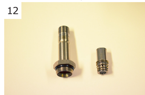
12 Ta ut den inre delen och kontrollera så att ingen smuts eller partiklar finns i kolven.
