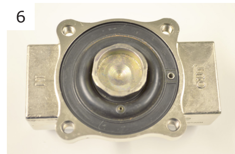
6 Ta loss det svarta membranet från ventilen
