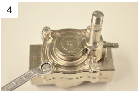
4 Lossa de fyra skruvarna med fast nyckel eller skiftnyckel. Nyckelvidd 8 mm.
