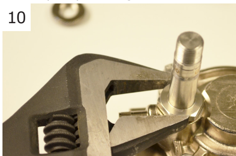
10 Skruva av kolv för spolen i överdelen av ventilen med fast nyckel eller skiftnyckel. Nyckelvidd 16 mm.
