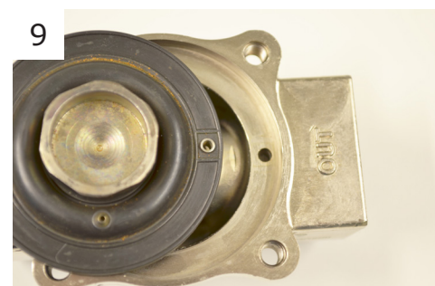
9 Sätt tillbaka membranet på ventilen. Obs! se till så att hålet med styrpinne hamnar i det lilla hålet på ventilen.
