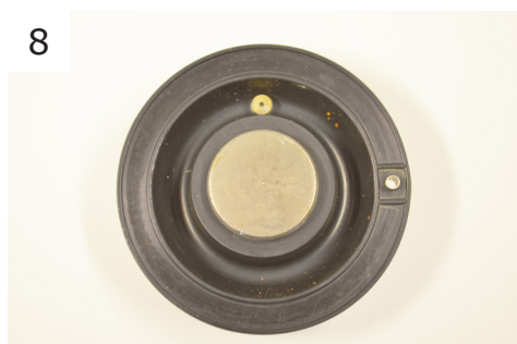
8 Rengör undersidan av membranet vid behov, samt se så att det inte är sprucket. Kontrollera att de två hålen är rena.
