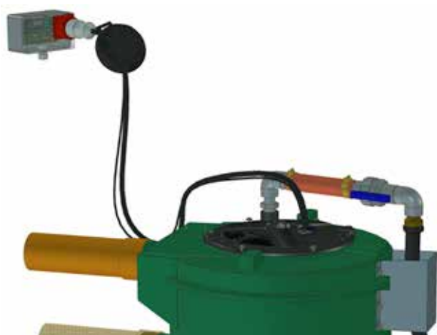
5. Se till att utloppsventilen och eventuell servisventil vid tomtgräns är öppen. Anslut pumpens stickpropp till apparatlådan. Fäst tryckutjämnaren på kabeln.
