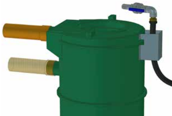
2. Montera utloppsventilen på utgående tryckledning. Centrum på ventiltröret skall ligga ca 14-15cm över pump-sätet.
