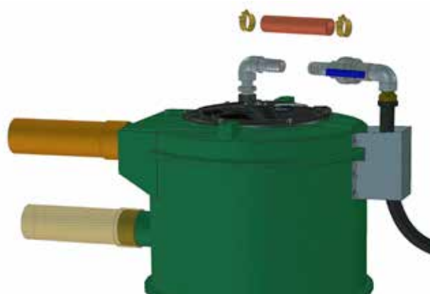
4. Montera den flexibla utloppsslangen med de två slangklämmorna.
