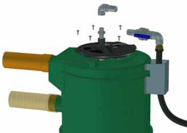
3. Montera pumpen. Notera att pumpen skall monteras vriden så att utloppsrörets position ligger klockan 2 om inloppen ligger klockan 12.
