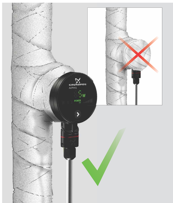
Fig. 6 Isolering av pumphus
