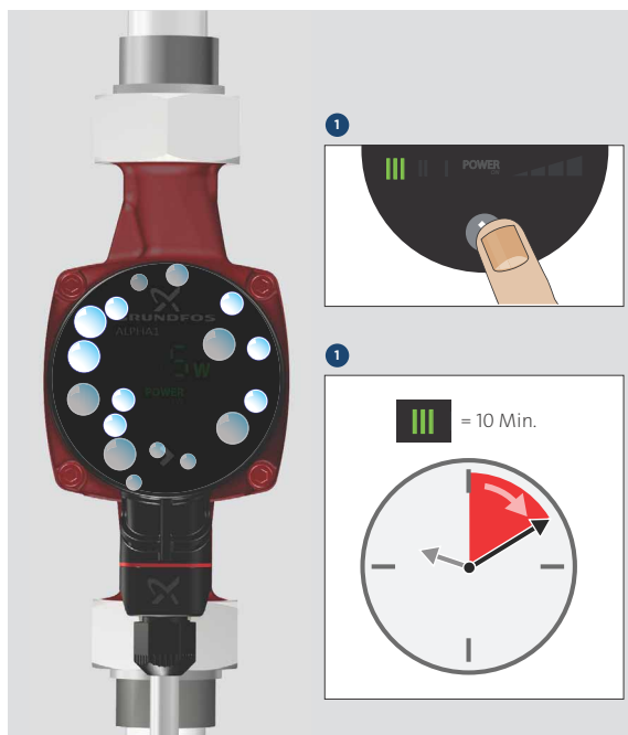
Fig. 12 Avluftning av pump
