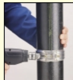
Dra ihop med skruvdragare alt. spärrnyckel (6 mm insex).
