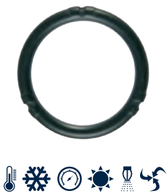
C1451 O-ring med LBP-funktion (svart, EPDM) för syrafast och elförzinkat stål (EJ för koppar!)
