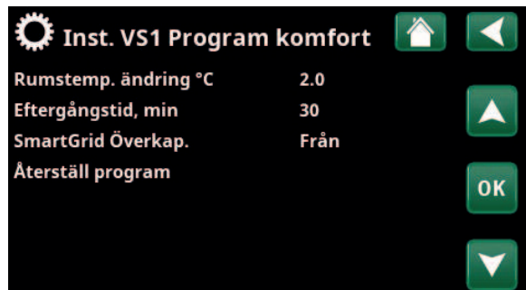
Meny "Avancerat/Inställningar/Värmesystem/Värmesystem 1/ Program/Komfort".
