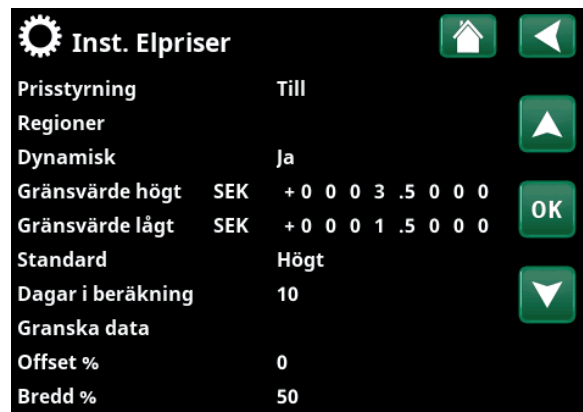
Meny "Avancerat/Inställningar/Kommunikation/Elpriser" vid val "Avancerat/Definiera/Kommunikation/myUplink:Ja".
