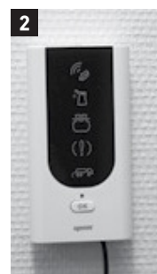
Infopanelen är ansluten till ett eluttag via nätadaptern, som ingår i paketet och monteras på vägghållaren.
