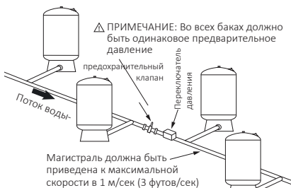
Рис. 1.5 Установка нескольких баков
