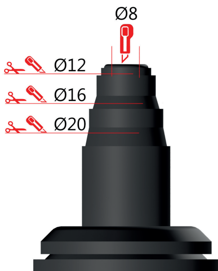
Kapning av rör genomföring.
