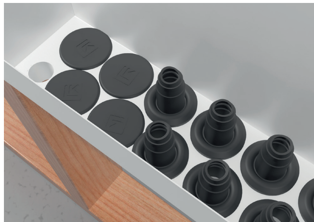
Principbild: montera rörgenomföringar och tätningspluggar
