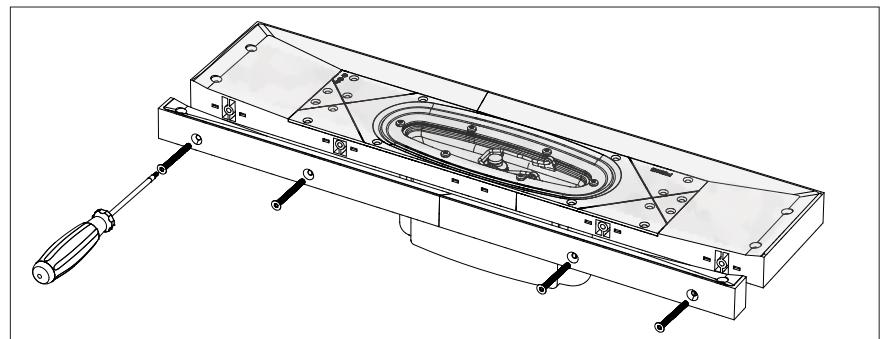
Sätt ihop vänster och höger bit. Använd medföljande skruvar för att montera i brunnen. Put the left and right counterpart together. Use the supplied screws to mount in the drain. Sett sammen venstre og høyre del. Bruk skruene som fulgte med, til å montere i sluket.
