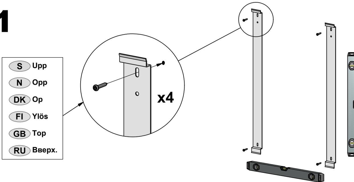
Skruvinfästningar i våtzon 1 ska göras i massiv konstruktion såsom betong, regler, särskilda konstruktionsdetaljer eller i Våtrumsvägg 2012.
