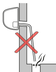
Dräneringsröret ligger för nära en illaluktande källa
