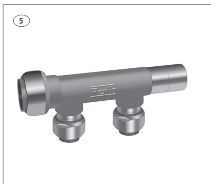
5. Sammankoppling av Roth Insticksfördelare. Fördelarröret sticks in i varandra till stopp. Rören kan sedan vridas till önskad vinkel så att kopplingsledningarna kan stickas in.
