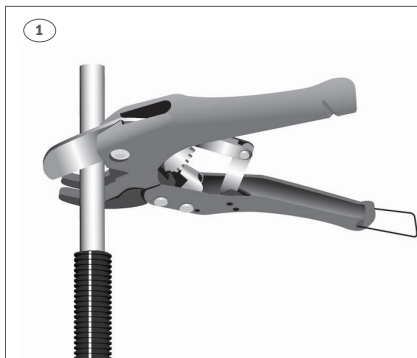
1. Kapa MultiPex® röret vinkelrätt med en Pex röravskärare.
