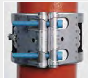
4. Boltene tildras til svepets brøer møter hverandre. Kragens tenner griper nå rundt begge rørender og sikrer sammenføyningen mot trykk opp til 10 bar.
