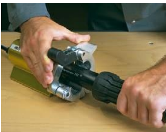
Skjut in röränden i uppkragningsverktyget så långt det går och vrid ner låsarmen. Starta expansionsprocessen genom att trycka lätt på startknappen (4) på hydraulenheten.
