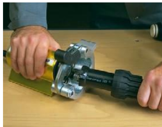
Öppna låsarmen och ta ur det uppkragade Sanipex MT®-röre från uppkragningsverktyget.
