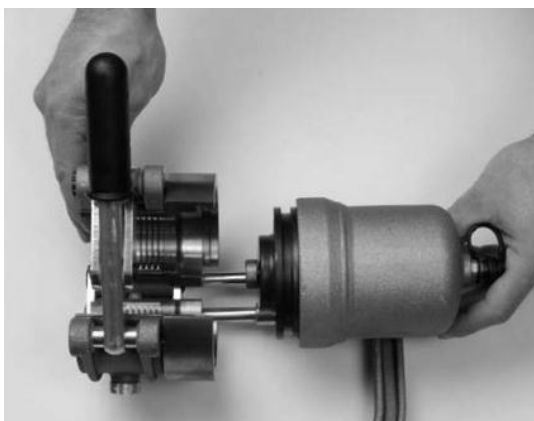
Fastspänningenheten skjuts över styrpin- narna (Handtaget längst bort från arbets- cylindern).
