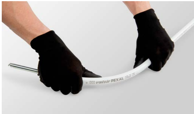
Figur 12 Bockning med verktyg.
