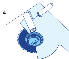
Utbredning av vattenisoleringsflänsen
