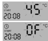
6. Programmer STOP sonens starttid. STOP ikonet lyser opp og timesifrene blinker. Endre aktiv parameter med pilknappene og trykk deretter på TIMER knappen
