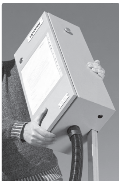
Montera styrsåkåpet på stativ och fäst upp slangen.
