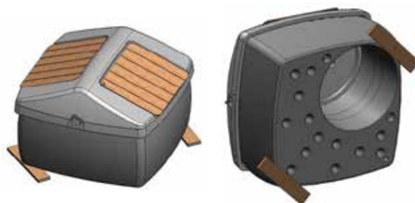
Bild 26a–26b. Fäst förankringsribbor i de två inserterna i botten av apparatskåpet med två M10 bultar som ingår i leveransen. Lyft kemikaliebehållaren och tömningssumpen ut ur apparat-skåpet för att det ska vara lättare att vända på apparatskåpet. Vänd apparatskåpet så att sidan med kopplingsdosan och kompressorn kommer mot marken medan förankringsribborna fästs.
