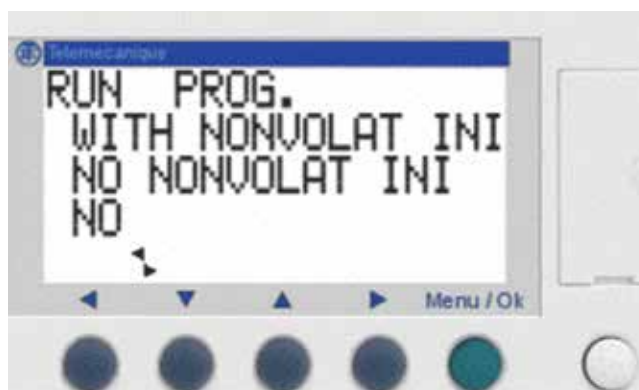
Bild 8. Zelio-reläets RUN / STOP meny.
