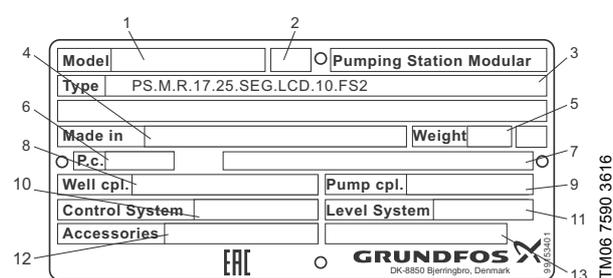
Fig. 3 Nameplate, PS.M
