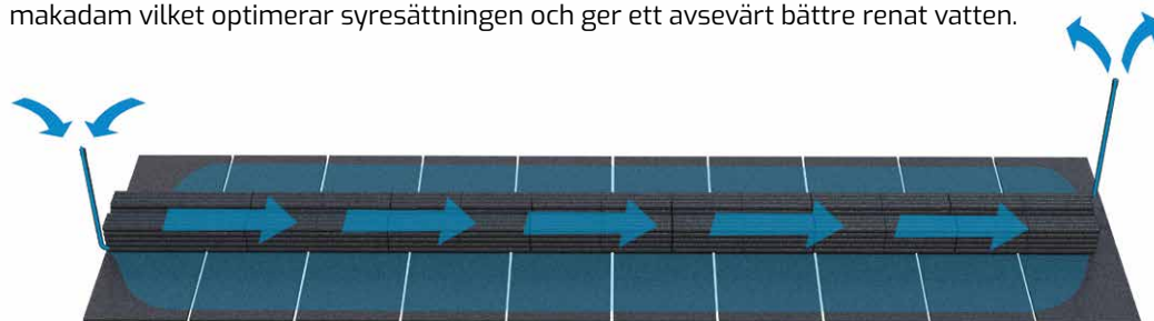
Bilden visar luftflödet i bioModuler och spridarplattor.
