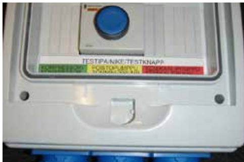
Bild 34. Förenera kompressorns elledning till kopplingsdosans gröna uttag. Kemikaliepumpens elledning och stickkontakt är märkta med grönt. Kontrollera att kemikaliepumpens elledning är kopplad till det rödmärkta uttaget. Kemikaliepumpen är färdigkopplad till kopplingsdosans uttag. Tömningspumpens elledning är märkt med gult. Tömningspumpens elkontakt kopplas till det gulmärkta uttaget.
