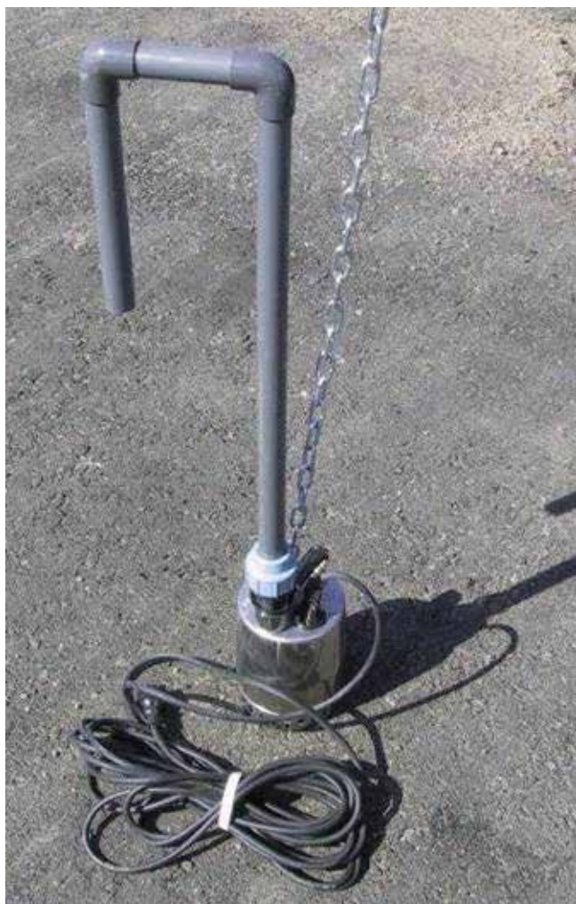
Bild16a+b. Installering av tömningspumpen i inspektionsbrunnen.
