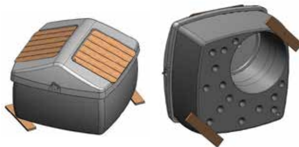
Bild 26a–26b. Fäst förankringsribbor i de två inserterna i botten av apparatskåpet med två M10 bultar som ingår i leveransen. Lyft kemikaliebehållaren och tömningspumpen ut ur apparatskåpet för att det ska vara lättare att vända på apparatskåpet. Vänd apparatskåpet så att sidan med kopplingsdosan och kompressorn kommer mot marken medan förankringsribborna fästs.
