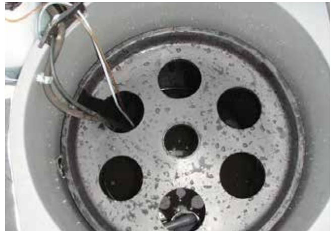
Bild 36. Placera tömningspumpens elledning, luftningslag och kemikalieslang i processtanken, med säkerhetslocket på plats. (Gäller endast modell BioKem 6 EN). Stäng apparatskåpets låsbara lock.
