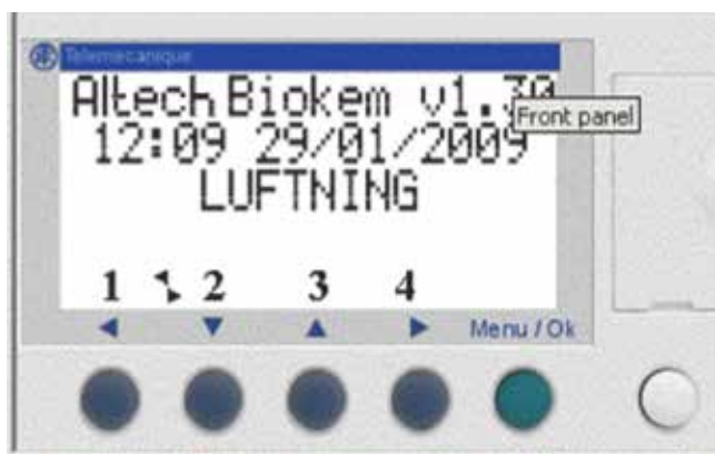
Bild 5. Zelio-reläet i RUN-läge.
