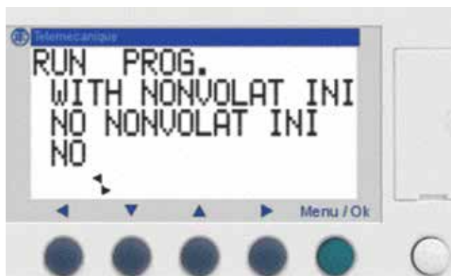
Bild 8. Zelio-reläets RUN / STOP meny.
