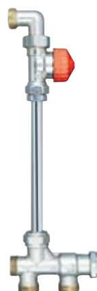
Radiatorkoppel Tworett 2-Rör Underkopplad fördelare RSD 802 TRV-2S. Rak, 5-78 l/h (vid 10kPa). Vridbar ventil med förinställning. Exkl. kopplingar. Ventil del TRV- 2S har röd skydds ratt.
