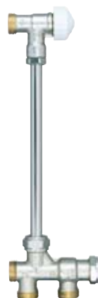
Radiatorkoppel Flowrett 1-Rör Underkopplad fördelare RSD 801 Kvs 1,2. RVT Vinkelventil. Exkl. kopplingar.
