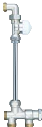
Radiatorkoppel Tworett 2-Rör Underkopplad fördelare RSD 802. TRV- 2. Rak, 15-130 l/h (vid 10kPa). Vridbar ventil med förinställning. Exkl. kopplingar.
