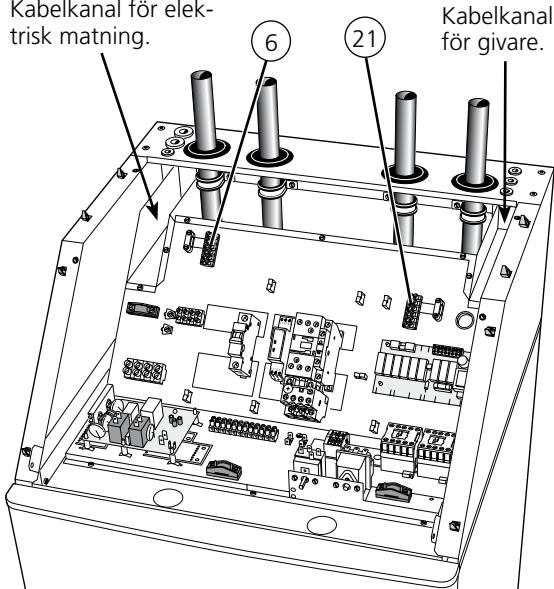
Kabelkanal för givare.
