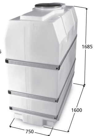
Volym 1600 liter Art. nr 21602*, Art. nr 21604** Vikt 126,0 kg, med manlucka ø 400 mm * 3 st förstärkningsramar i mtrl SS 2343 ** 3 st varmförzinkade förstärkningsramar
