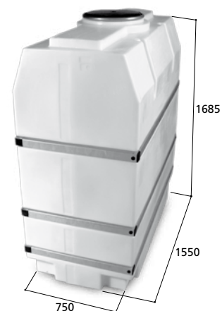
Volym 1600 liter Art. nr 21602*, Art. nr 21604** Med manlucka Ø 400 mm * 3 st förstärkningsramar i mtrl SS 2343 ** 3 st varmförzinkade förstärkningsramar
