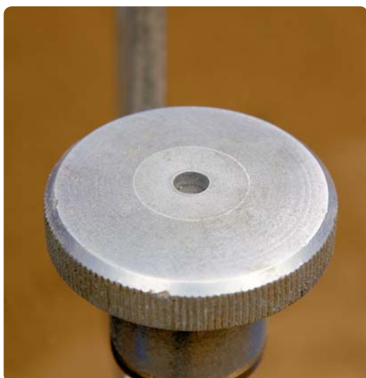
6. Hållverktyget ska spännas så mycket att skruven i mitten är jäms med ytan.
