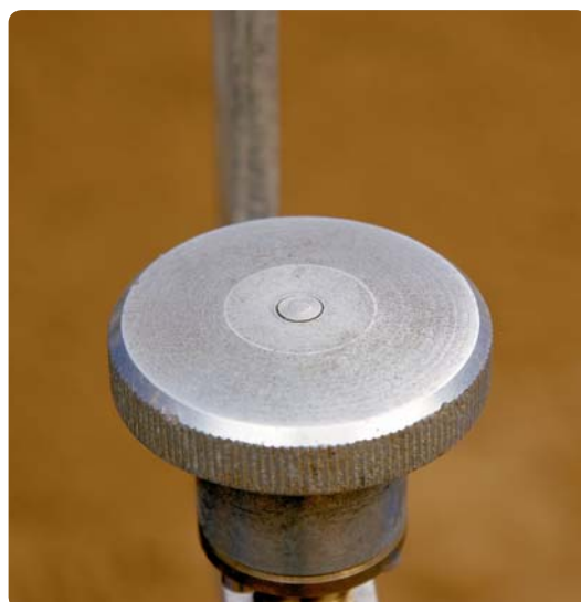
6. Hållverktyget ska spännas så mycket att skruven i mitten är jäms med ytan.
