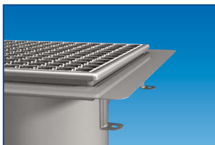
Golvtyp Klinker K4 men med 50 mm bred fläns. Avsedd för tätskikt med tätning-/ armeringsband som är utprovat för "smal" klisterfläns*.
