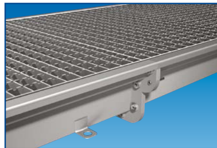
Skarvfläns. För brunn med bredd upp till 400 mm. Endast ihop med klinker K3, massagolv och stålslipat betonggolv.
