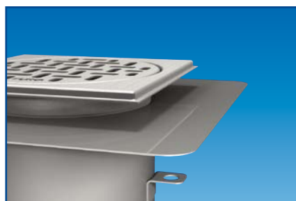
Extra ställbarhet för bottenutlopp: Ökar ställbarheten mellan överdel och brunn till 0 - 60 mm.
