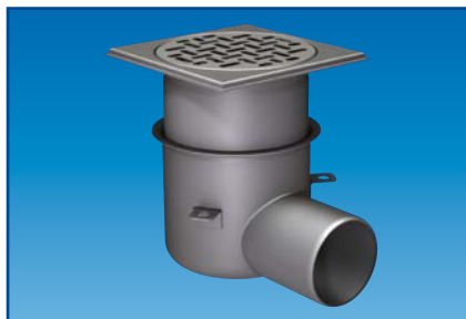
Påbyggnadsdel*. Om 5 dl silkorg eller sandfång väljs som tillbehör till golvbrunnen, krävs en påbyggnadsdel. Totalhöjden blir då samma som för brunn med ett inlopp.
