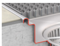
Betong-, massa- och klinkergolv utan tätskikt
