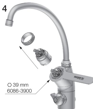
SE Byte av tätningssringar
