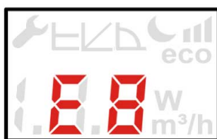
Bild 14: Indikering felmeddelande E8 (motorfel)
