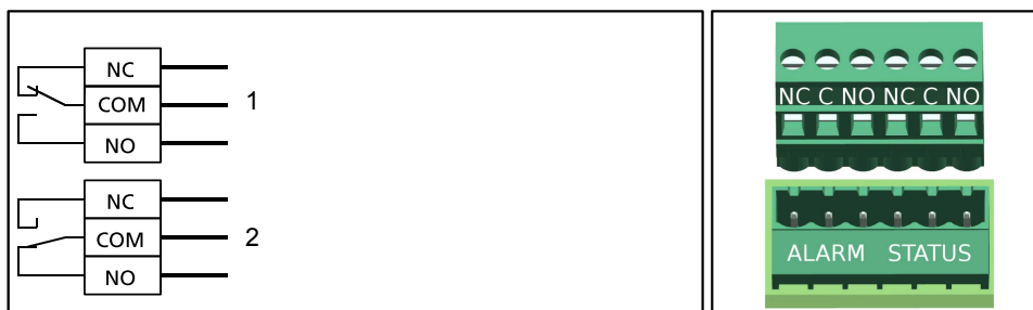
Bild 10: Elektriskt anslutningsschema samlingsfelmeddelande
