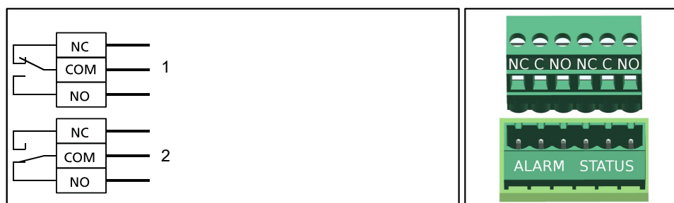
Bild 10: Elektriskt anslutningsschema samlingsfelmeddelande
