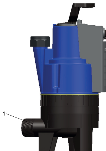
Bild 11: Ansluta rörledningen, pumpstorlek 354
