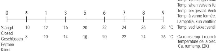
Ventilen stängs för flöde när termostaten är inställd på siffran 0. Vid service/underhåll rekommenderar vi att anslutande ledning propas.
