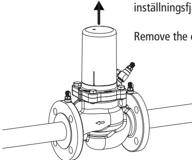
Lossa den övre låsmuttern, därefter kan den nedre muttern för förinställning av differenstrycket justeras. 24mm nyckel (DN50-DN80) och 36/40mm nyckel (DN100-DN150)
