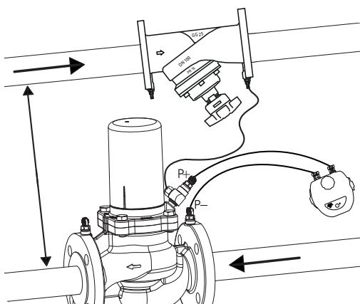
Differenstrycket i systemet ställs in med hjälp av verktyget MMA Maxor, som ansluts direkt till ventilens mätnipplar.
