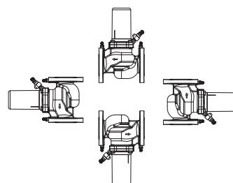
PV Compact ska monteras på returledningen och kan placeras i alla riktningar. Pilen på ventilen indikerar vilken flödesriktning ventilen ska monteras i.
