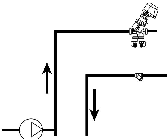
Kan monteras både på tillopp och retur. Vi rekommenderar att man även monterar smutsfilter och avstängningsventil. Temperaturen runt ställdonet bör inte vara under 0°C. TOV kan endast användas som avstängningsventil då trycket kommer i pilens riktning.
