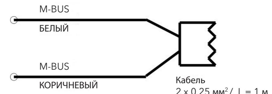
Удлинение кабеля в соотв. со стандартом M-Bus
