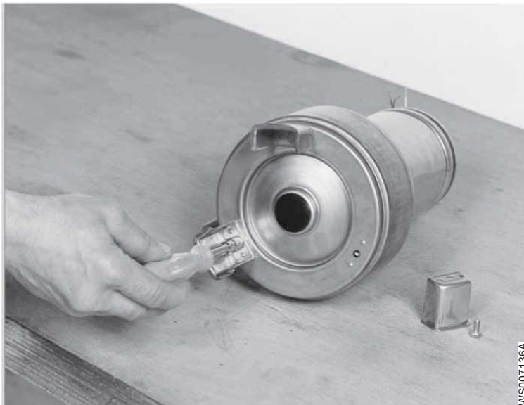
Figur 20: Avlägsnande av pumpfötter
