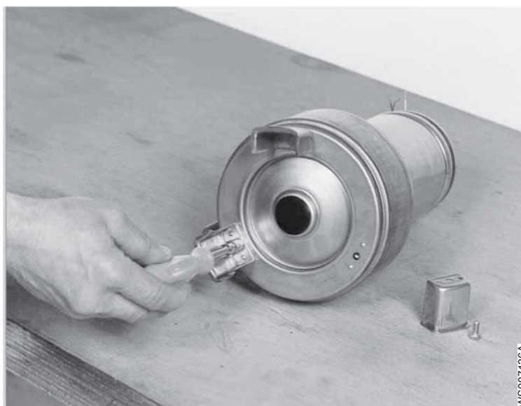
Figur 9: Avlägsnande av pumpfötter
