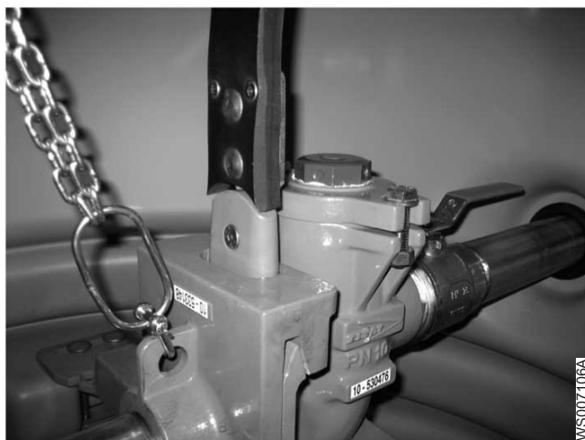
d) Stoppa nedsänkningen när glidskon kommer i ingrepp med tryckanslutningen med backventilen.
