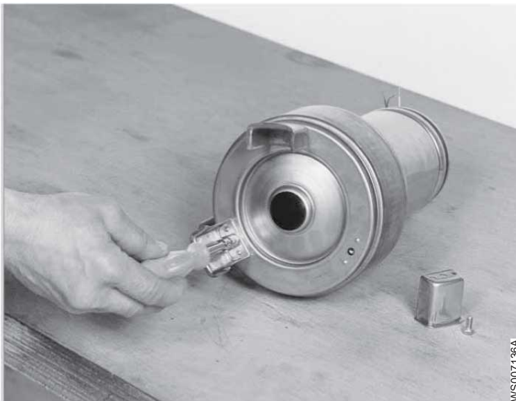
Abbildung 34: Entfernen der Pumpenfüße
